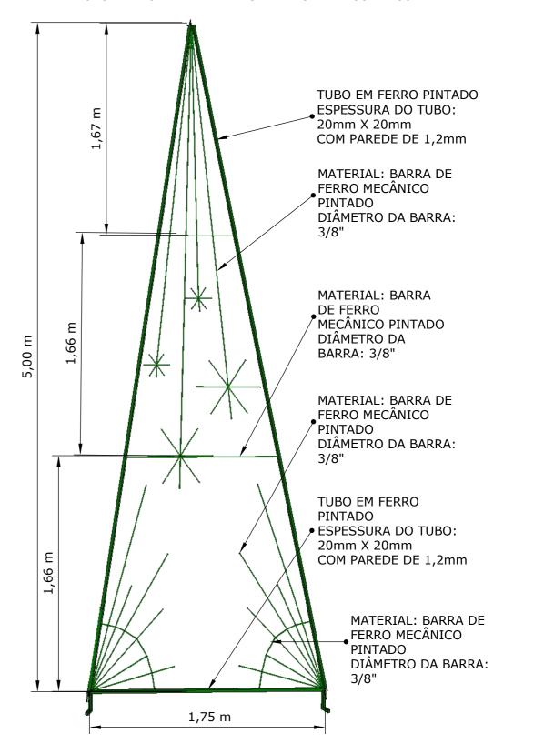
MODELO 07 QUANTITATIVO DE MATERIAIS (INCLUINDO 10%) 04 ARCOS COM ALTURA DE 3,00m MATERIAL: TUBO DE FERRO PINTADO **DESCRIÇÃO** QUANTIDADE COM PAREDE DE 1,20mm ESPESSURA DA BARRA: 20mm X 20mm TUBO DE FERRO PINTADO COM PAREDE DE 1,20mm E ESPESSURA COM DIMENSÕES DE 20mm X 20mm 48,50 m 04 ARCOS COM ALTURA DE 1,80m MATERIAL: TUBO DE FERRO PINTADO COM PAREDE DE 1,20mm ESPESSURA DA BARRA: 20mm X 20mm 2,83 m 1,00 m
