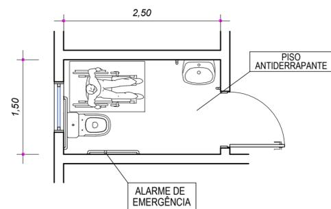
**FIGURA 108 -** Bacia com caixa acoplada barras de apoio ao fundo e a 90° na parede lateral - Exemplo C
