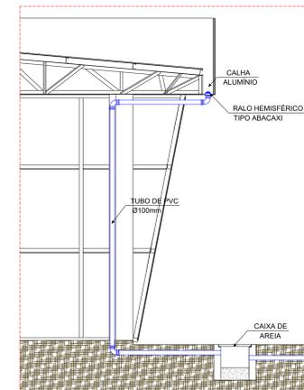
Detalhe - Calha e Coletor Pluvial
