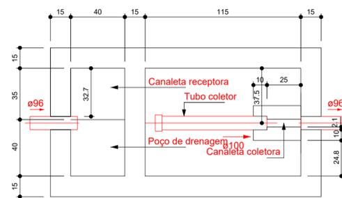
Planta baixa - Filtro anaeróbico
