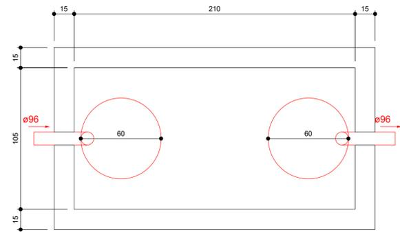
Planta baixa - Tanque séptico
