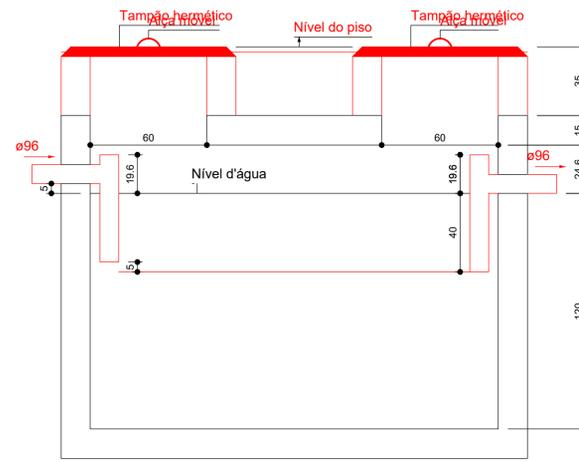
Corte - Tanque séptico
