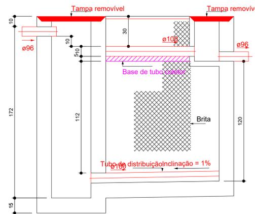
Corte - Filtro anaeróbico
